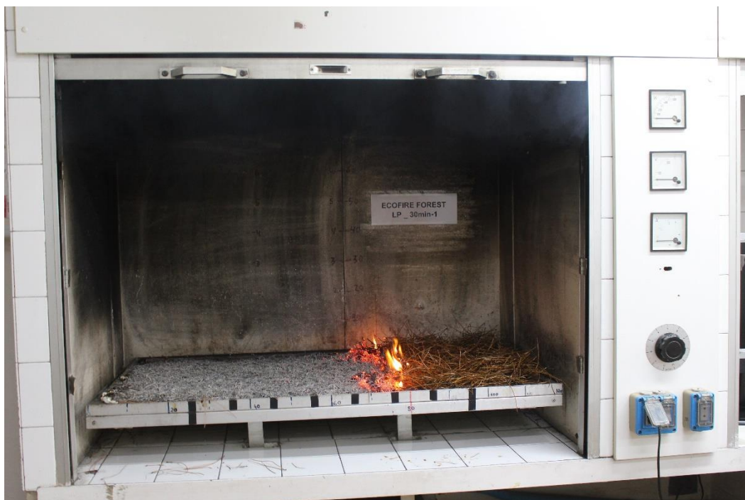
Fotografía nº 5.- Vista del avance del fuego en la zona tratada, para el tratamiento 1 (30 minutos en estufa)
