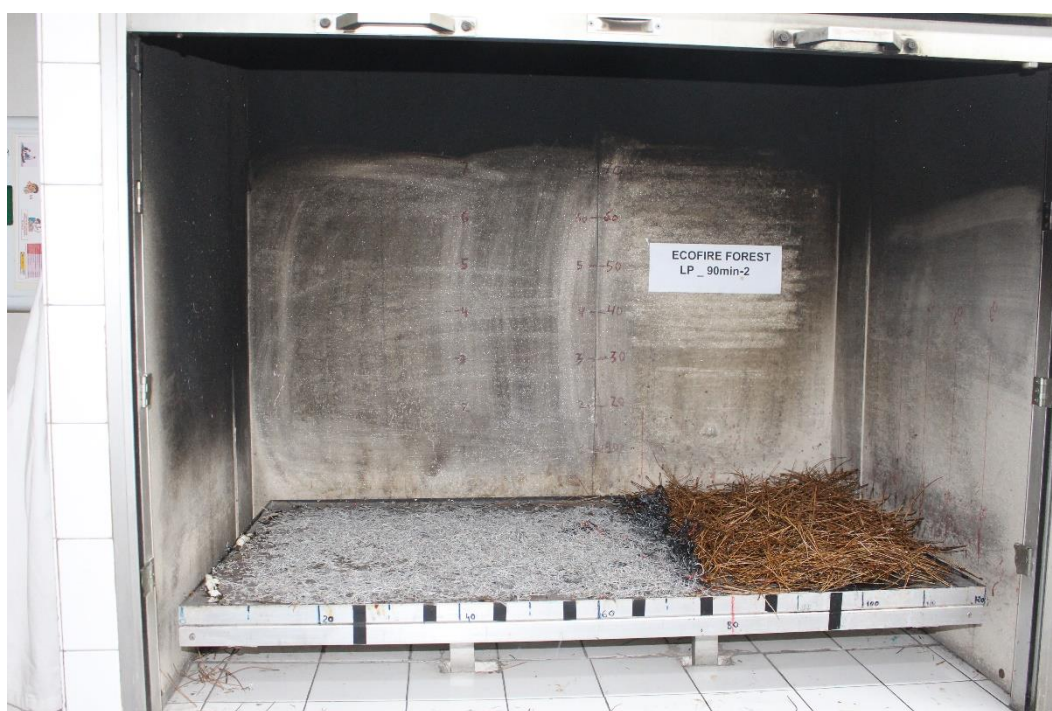
Fotografía nº 12.- Vista del residuo al final del ensayo, para el tratamiento 2 (90 minutos en estufa)
