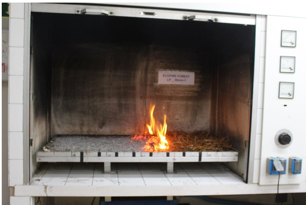
Fotografía nº 3.- Vista del avance del fuego al entrar en la zona tratada, para el tratamiento 1 (30 minutos en estufa)
