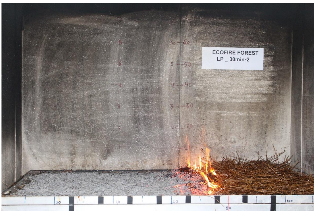
Fotografía nº 10.- Vista del avance del fuego en la zona tratada, para el tratamiento 2 (90 minutos en estufa)
