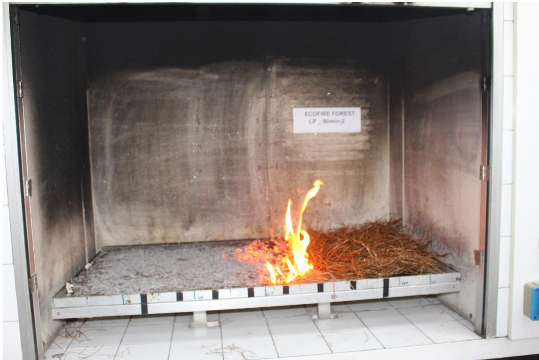
Fotografía nº 9.- Vista del avance del fuego al entrar en la zona tratada, para el tratamiento 2 (90 minutos en estufa)
