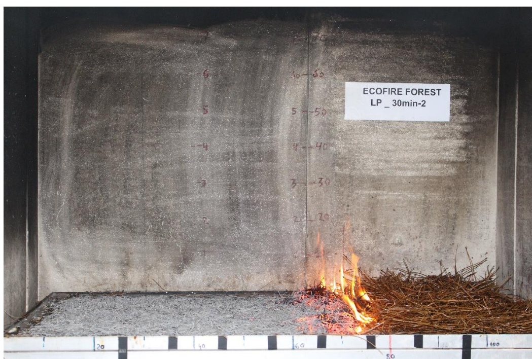
Fotografía nº 4.- Vista del avance del fuego en la zona tratada, para el tratamiento 1 (30 minutos en estufa)
