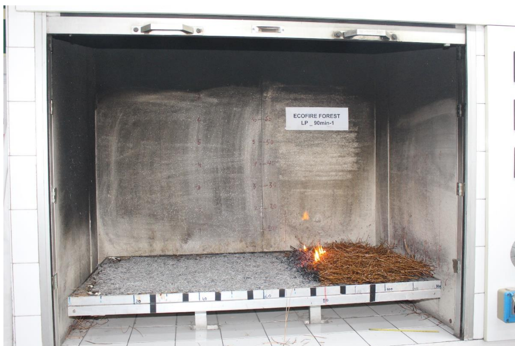
Fotografía nº 11.- Vista del avance del fuego en la zona tratada, para el tratamiento 2 (90 minutos en estufa)
